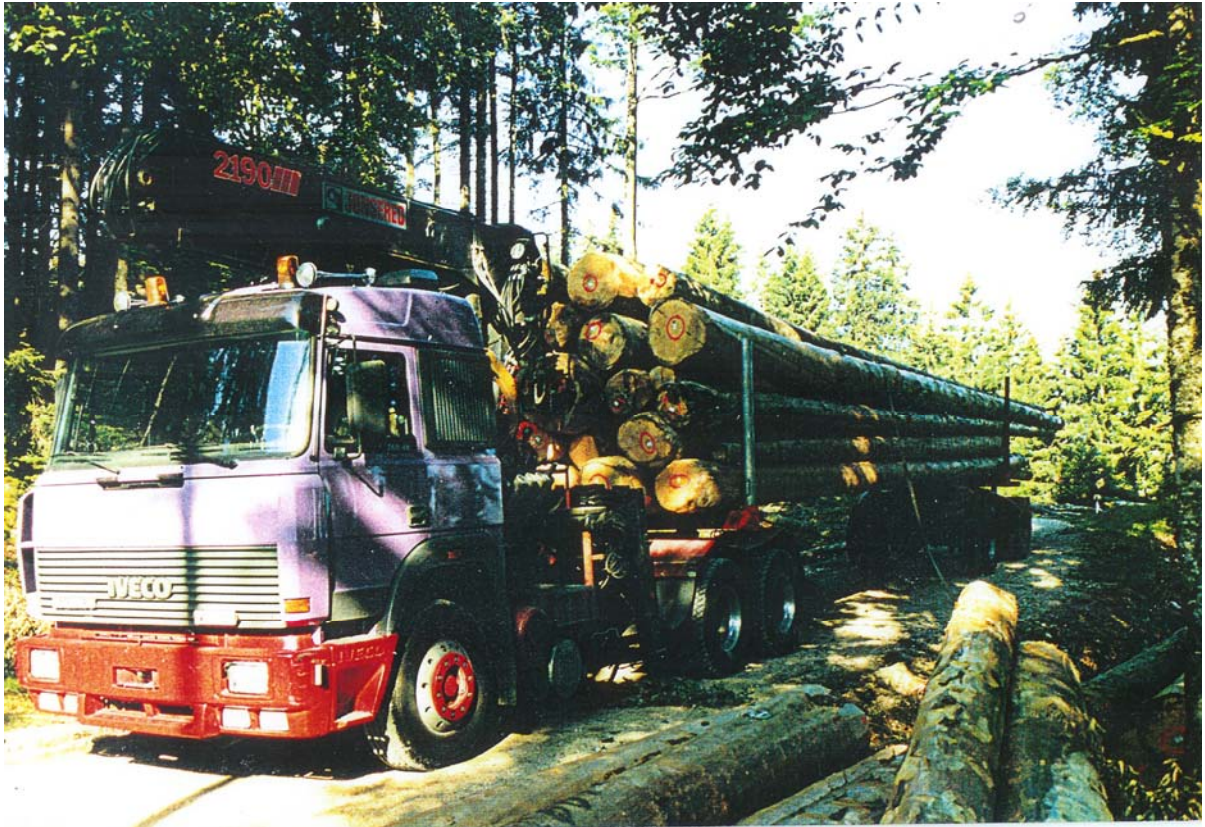
La grue a remplacé le treuil.
